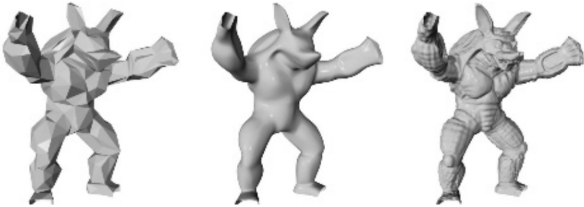
图 17.52：左边是一个粗糙的控制网格。中间采用了 Loop 细分方案进行细分。右边展示了位移细分表面。
