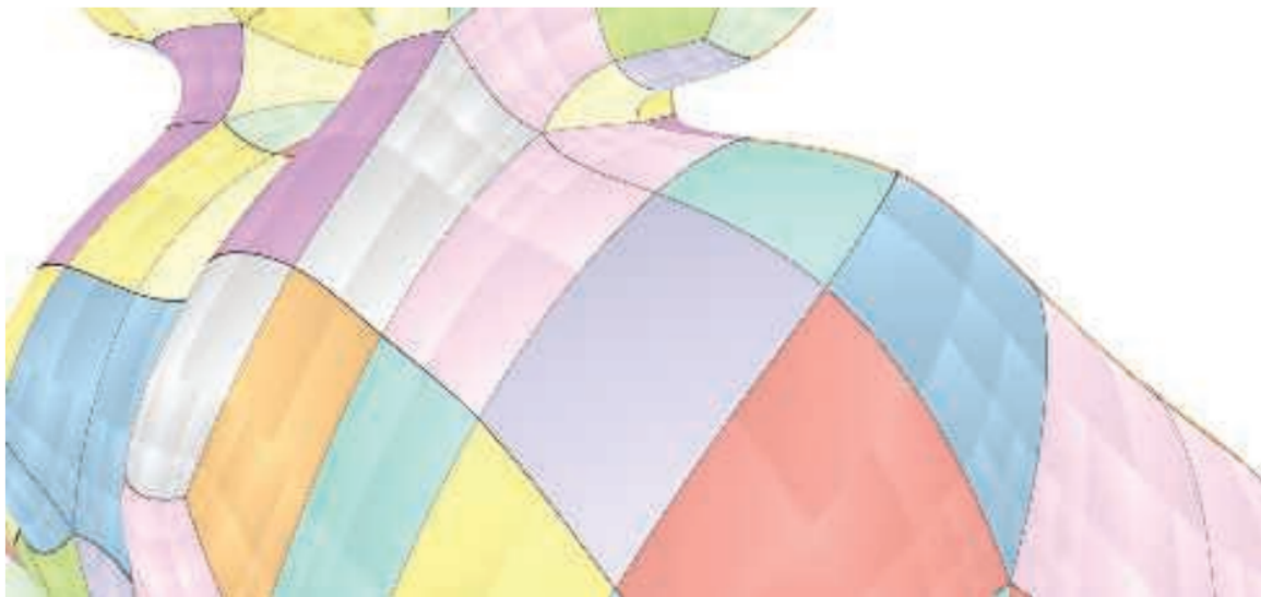
图 17.70：使用了自适应四叉树的细分面片。每个面片都有一个对应的基础网格面片，在图中使用黑色曲线进行表示，每个面片内部的分层结构说明了细分步骤。我们可以看到，在中心有一个颜色均匀的面片（灰紫色）。这意味着它被渲染为一个双三次 B 样条面片，而其他（具有特殊顶点）的面片则清楚地展示了其潜在的自适应四叉树结果。
