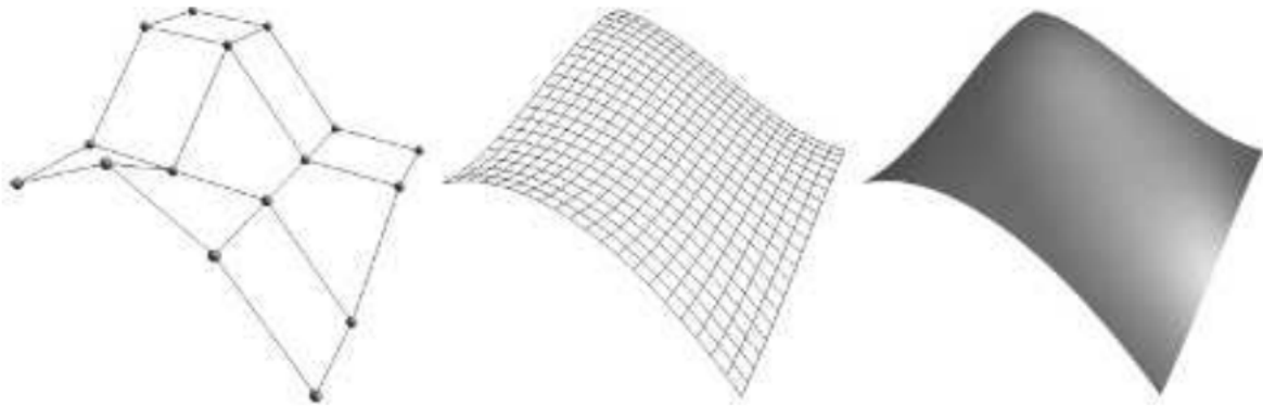
图 17.20：左：一个 4 \times 4 的控制网格，可以构建一个 3 \times 3 自由度的 Bezier 面片。中间：展示了在这个 Bezier 表面上生成的实际四边形网格。右：对这个 Bezier 面片进行着色。
